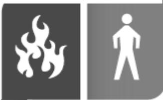
Fähigkeit eines Bauteils mit raumabschliessender Funktion einer Brandbeanspruchung zu widerstehen – ausreichend starke Hitzebarriere zum Schutz von Menschen ( $< 140 \text{ K}$  Mittel K Maximum).
